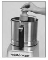
3) Наденьте нож на моторный вал и протолкните его на дно чаши.
